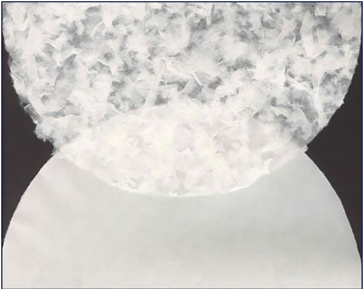
Fot. 5. Formowanie papieru z braku wodo utrwalonego – bez systemu KRIMA / po systemie KRIMA
